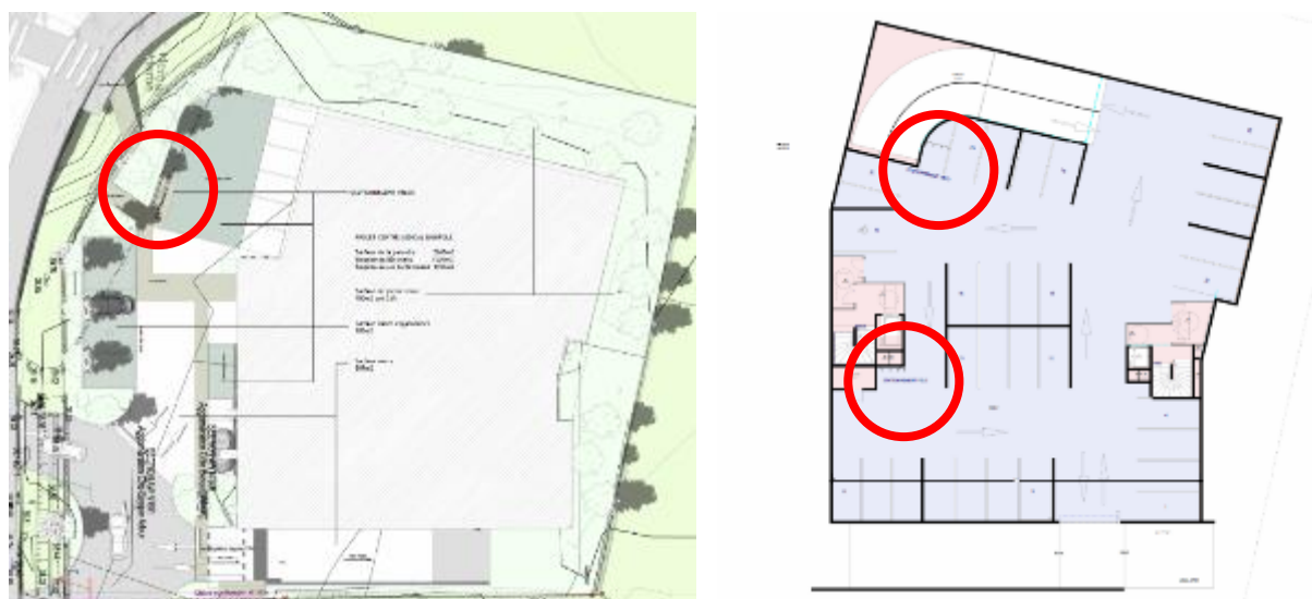
Localisation sur des extraits de plans de masse, des emplacements pour le stationnement des vélos au rez-de-chaussée (plan de gauche) et au sous-sol (plan de droite). Source : Rebeyrol architectes.
